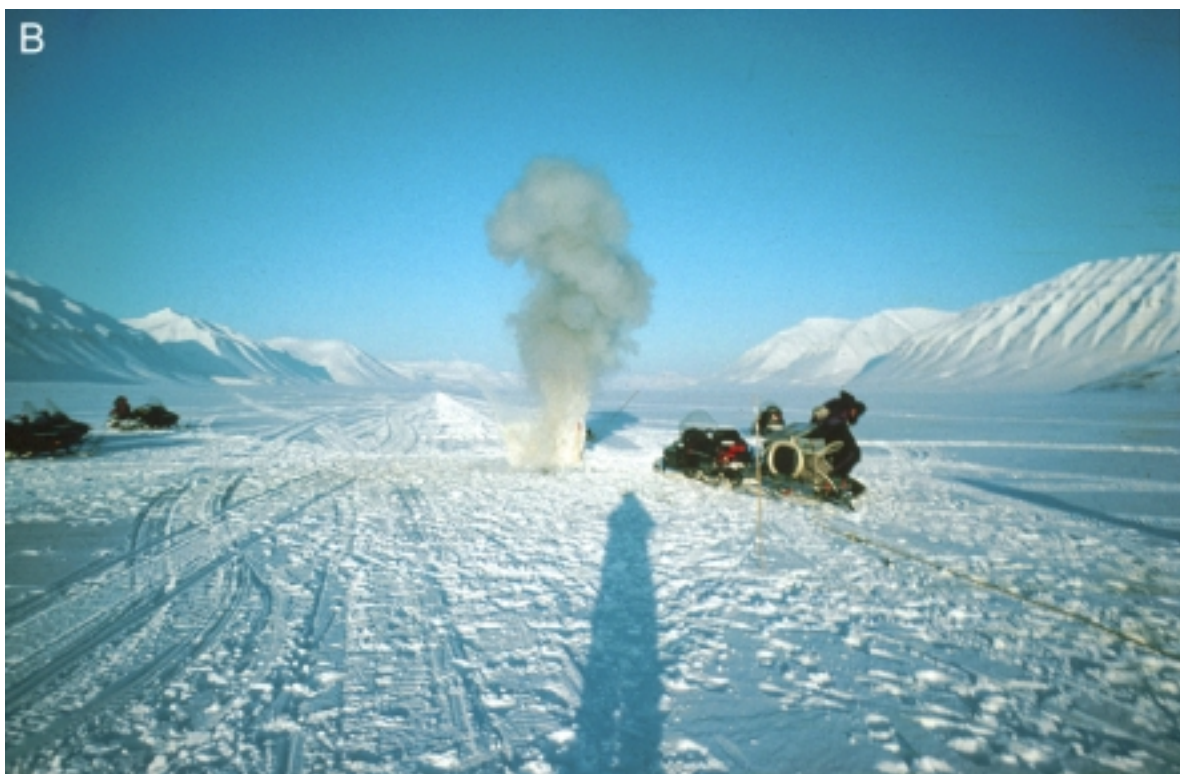
Fig. 5. (A) Braganzavågen mot Kjellstrømdalen sett mot nordøst fra Littrowneset og Crednemoenen ved start av linje 1, 24. mars. (B) Prøveskudd med detonerende lunte (100 g i 60 cm dyp hull) ved begynnelsen av linje 1, 24. mars. Næroffset 10 m. Uskarpt bilde skyldes ustø fotograf.
