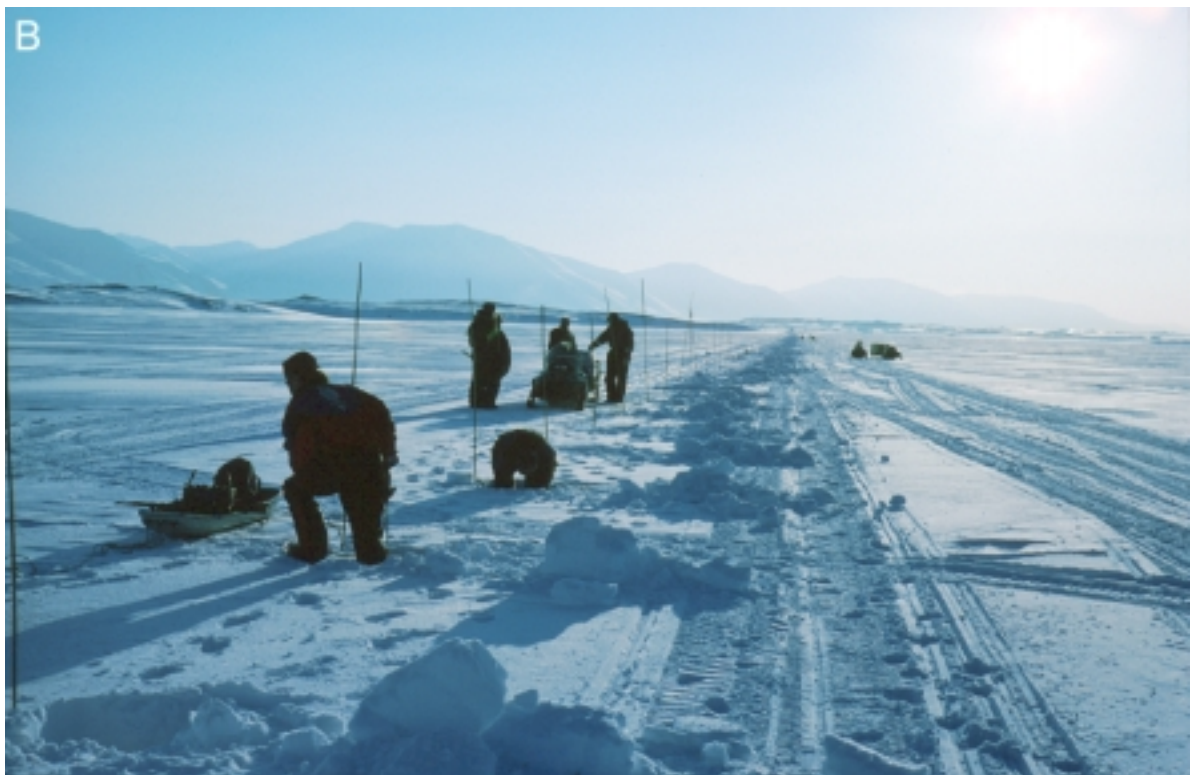
Fig. 7. Profilering ved linje 1 (25. mars) med utsikt mot nord (A) og sydvest (B). Skytelaget består av boreassistent (foran), ladeassistent (ved neste hull) og skytebas, operatør, og scooterfører (bak).
