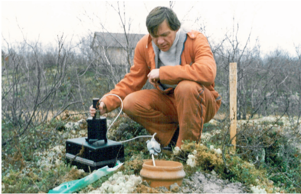
Un capteur sismique de courtes périodes prêt à être installé
