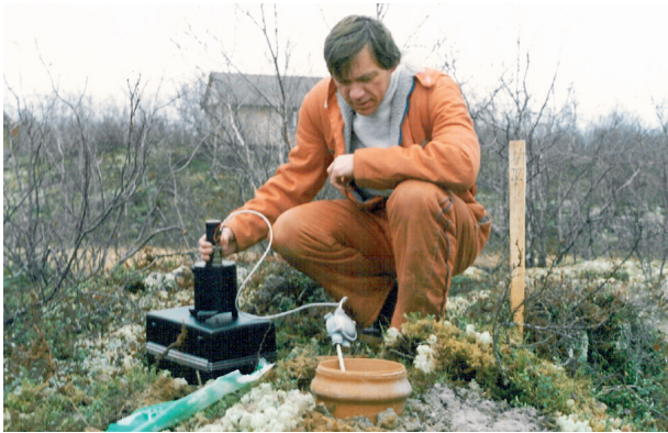
Un sensor de corto período listo para su instalación
