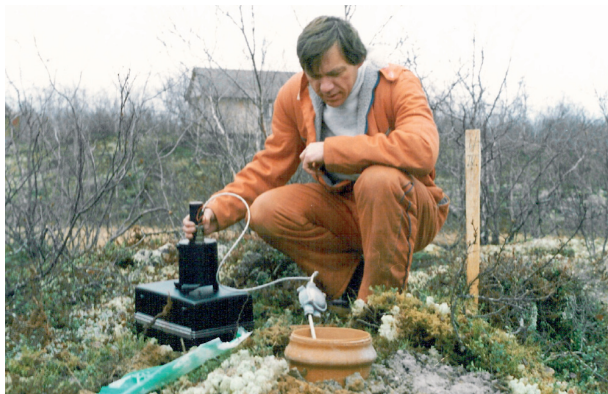
Ein kurzperiodischer Sensor ist fertig zum Einbau
